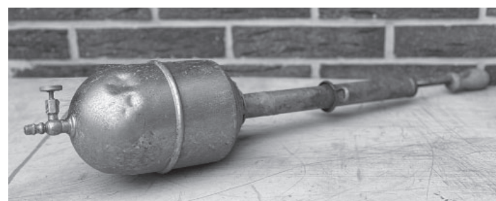
Paraffinspritze zur Erzeugung des verschneiten Effekts an selbstge bundenen Tannenbäumen
